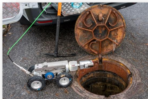
Foto: kamerový vozík s motorem s navijákem osazený rotační a výkvnou kamerovou hlavou
