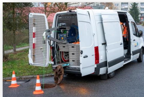
Foto: kamerový vůz Renault Master s vestavbou Rausch
